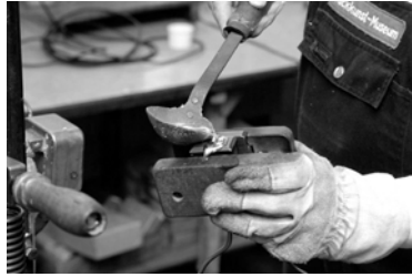
Vorführung des von Gutenberg erfundenen Handgießinstrumentes Foto: Museum
